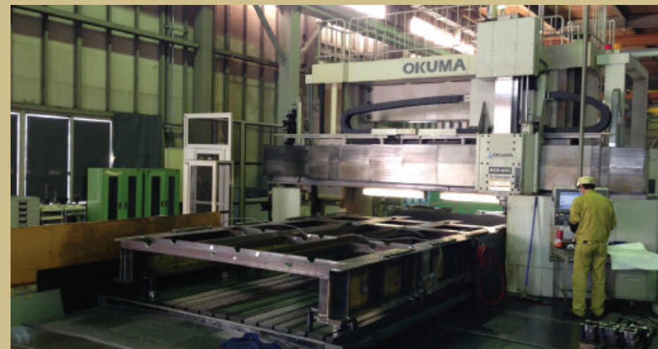
大型機械加工(写真上) 門型マシニングセンタ 幅3500mm×長さ6500mm
