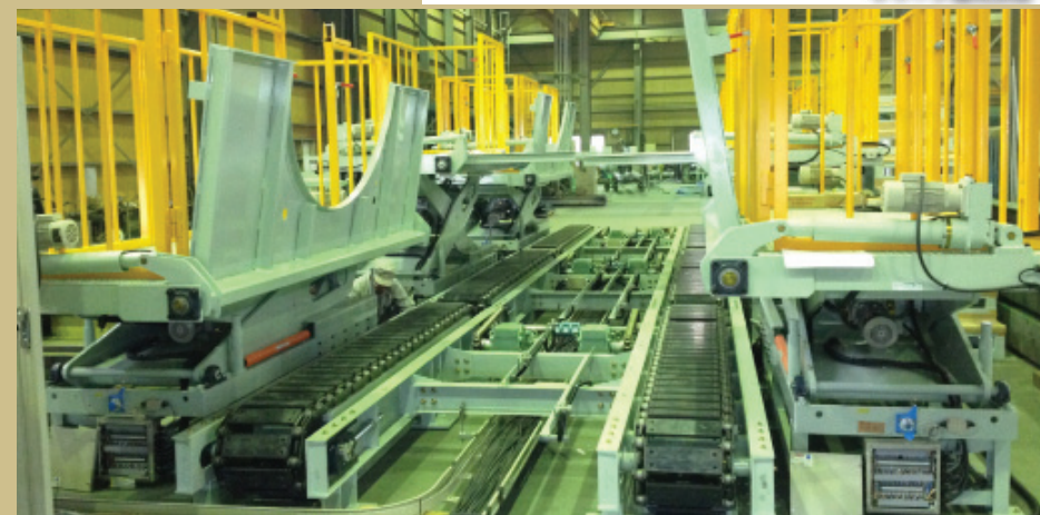
重機製造ライン(ワーク:20ton) 幅4000mm×長さ10000mm (写真下)
